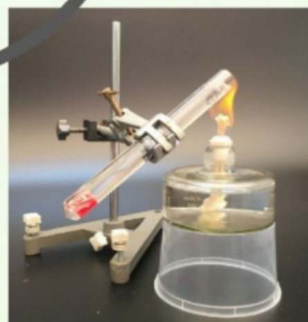
Hình 25.9. Đun ống nghiệm có chứa nước và một miếng sáp ở đáy ống
