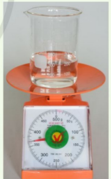
Hình 14.1. Số chỉ của cân là khối lượng của cốc đong có chứa một lượng chất lỏng
