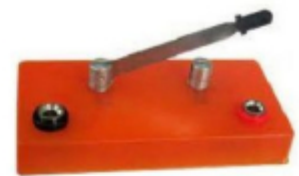
Hình 16. Công tắc đơn giản
