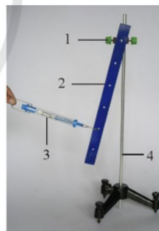
Hình 18.2. Kéo lực kế để thanh nhựa quay
